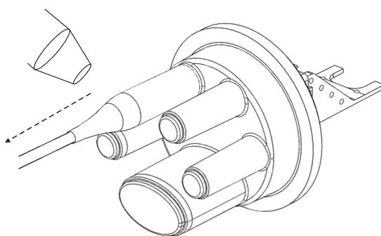
**8.4.7** Repita o item **8.3 FUSÃO DAS FIBRAS** desse manual para realizar a emenda por fusão das fibras que serão derivadas.
