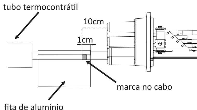
**8.2.4** Posicione o tubo termocontrátil ( $\varnothing 75/22$ ) sobre a entrada oval até encostar na base da caixa. Posicione o clipe metálico fazendo com que o tubo termocontrátil envolva os cabos ópticos e faça a união dos mesmos utilizando uma abraçadeira plástica à 5cm depois do alumínio. Conforme esquema abaixo:
