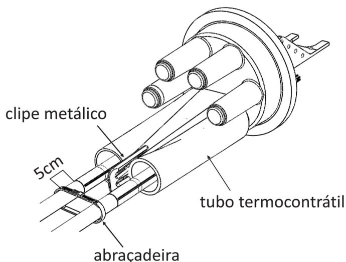
**8.2.5** Com o aquecedor (não acompanha o produto), realize a contração do tubo termocontrátil iniciando pela extremidade próxima à base da caixa, aquecendo toda a circunferência e direcionando no sentido dos cabos. Aqueça a extremidade do tubo até que o adesivo do clipe flua entre eles.
