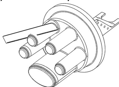
**Obs.:** A borda sem adesivo do tubo termocontrátil deve ser orientada para o lado da base, enquanto que a borda que possui adesivo deve ficar orientada para o lado dos cabos.
