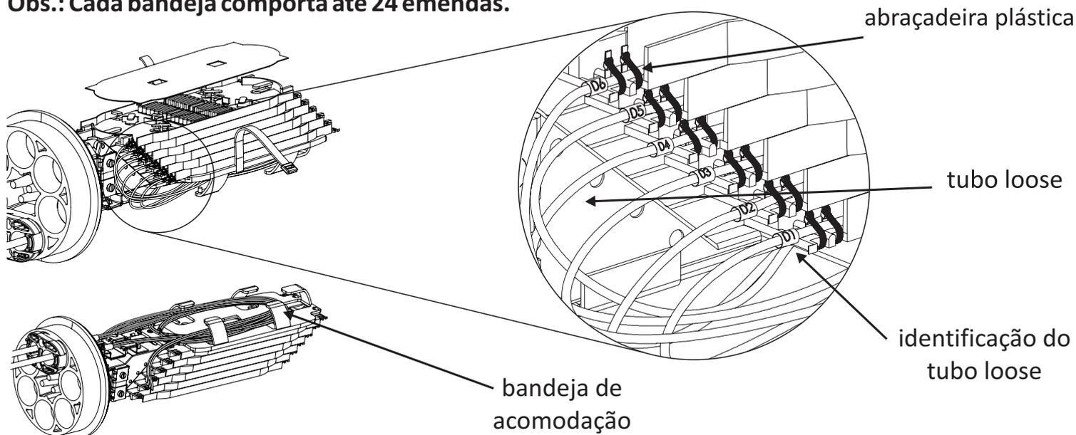
**8.3.2** As canaletas das bandejas podem alojar até duas emendas cada uma. Realize as fusões das fibras e armazene-as nas canaletas das bandejas. Acomode as fibras nos arcos da bandeja, conforme imagem ao lado:
