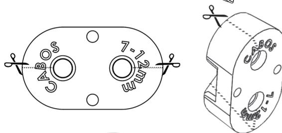
8.2.4 Aplique o lubrificante na superfície exterior, nos orifícios da borracha e sobre o cabo, para auxiliar na montagem.
