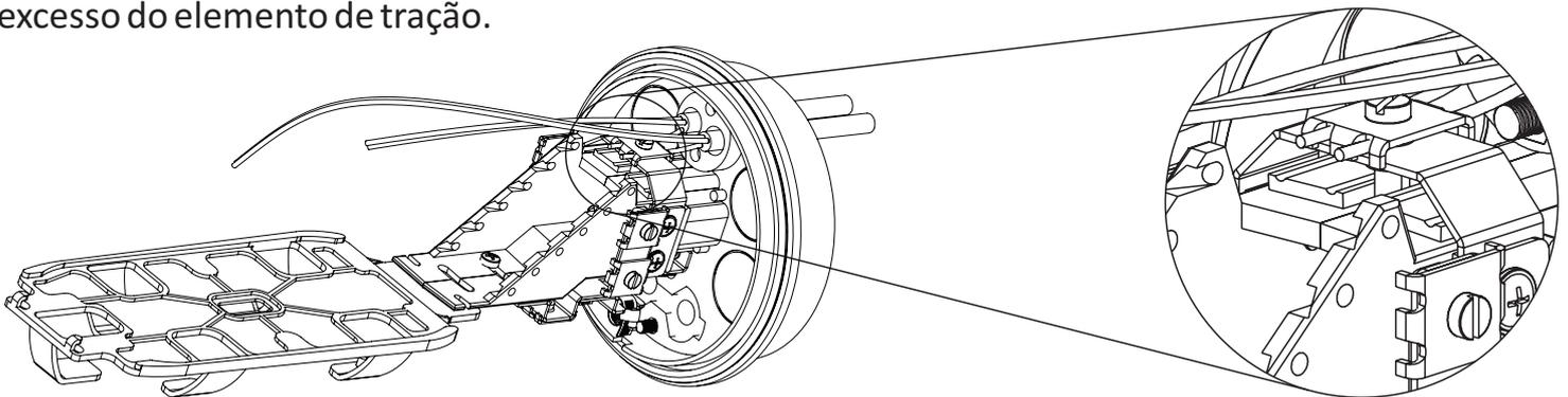
**8.4.9** Aperte os parafusos no derivador utilizando uma chave phillips (não acompanha o produto), conforme imagem abaixo.
