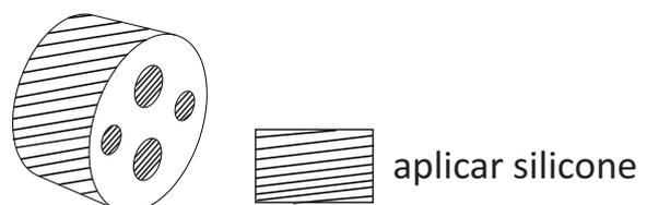
**8.4.6** Insira a trava inferior (sem inserto) e a borracha de vedação no (s) cabo (os), atentando-se para a angularização da borracha com os parafusos.
