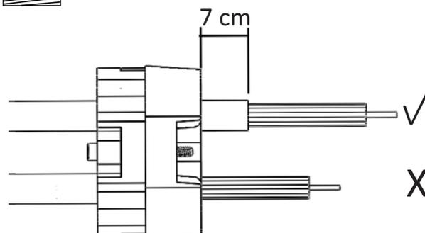
**8.2.6** Fixe o cabo de entrada com a abraçadeira metálica. Fixe o elemento de tração do cabo na estrutura da caixa, utilizando a arruela de fixação com o auxílio de uma chave de fenda (não acompanha o produto), conforme imagem a seguir. Retire o excesso do elemento de tração.
