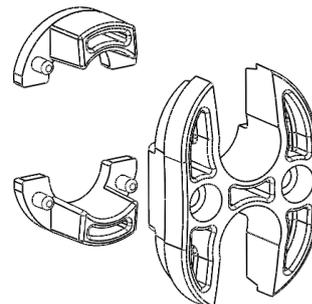
8.2.3 Para a instalação em **sangria**, faça um corte (conforme indicado a seguir) na borracha de vedação para passagem dos tubos loose.
