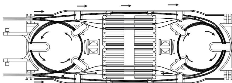
**8.3.3** Encaixe a tampa plástica retirada no item 8.3.1 e, após realizar o procedimento do item 8.3.2 para todas as fusões necessárias, una as bandejas utilizando a fita de velcro.
