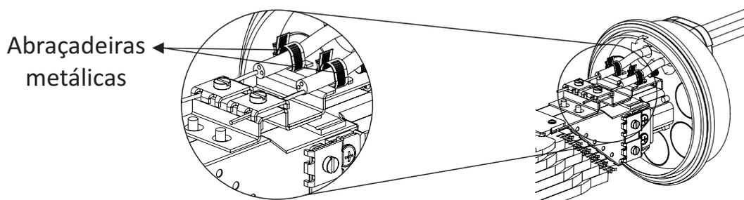
**8.2.7** Monte a trava plástica envolvendo os cabos no centro dos furos e passe os parafusos na trava, realizando o aperto, conforme mostrado a seguir:
