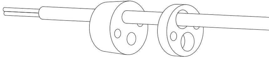
**8.4.7** Posicione a borracha na entrada de derivação deixando 3 cm da capa do cabo para o interior da caixa. Insira a trava superior (com inserto) pela parte interna da caixa, conforme imagens a seguir.
