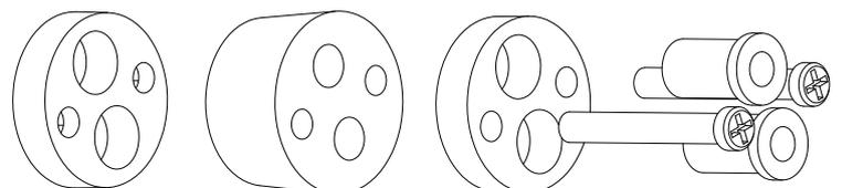
**8.4.5** Aplique lubrificante de silicone na superfície exterior, nos orifícios da borracha e sobre o cabo, para auxiliar na montagem.
