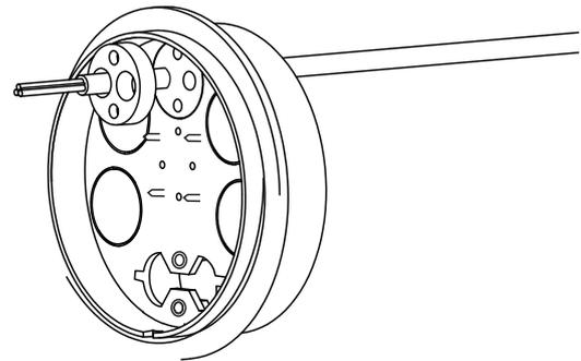
**8.4.8** Fixe o elemento de tração do cabo na estrutura da caixa, utilizando a arruela de fixação com o auxílio de uma chave de fenda (não acompanha o produto), conforme imagem a seguir. Retire o excesso do elemento de tração.
