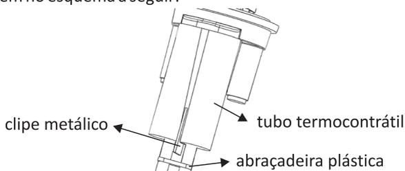
**8.3.5** Com um aquecedor termocontrátil (não acompanha o produto), realize a contração do tubo, iniciando pela extremidade próxima à base, aquecendo toda a circunferência e direcionando no sentido dos cabos. Aqueça a extremidade dos cabos até que o adesivo do clipe flua entre eles.
