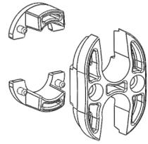
**9.3.3** Para a instalação em sangria, faça um corte (conforme indicado a seguir) na borracha de vedação para passagem dos tubos loose.
