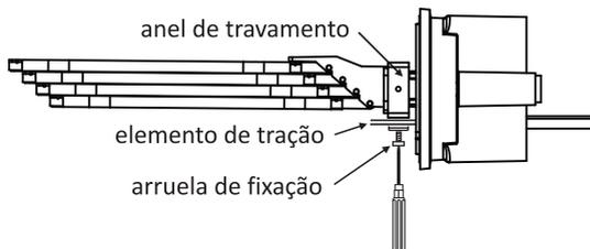
**9.3.7** Posicione a parte central da trava da reentrada entre os cabos e, em seguida, encaixe as extremidades da trava envolvendo os cabos, conforme imagens a seguir. Com o auxílio de uma chave phillips, realize o aperto da trava utilizando os parafusos da trava.
