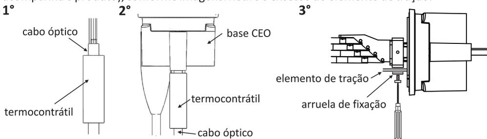
**Obs:** A borda sem adesivo do tubo termocontrátil deve ser orientada para o lado da base, enquanto que a borda que possui adesivo deve ficar orientada para o lado dos cabos.
