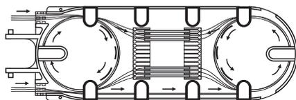
**10.3** Encaixe a tampa plástica retirada no item 10.1 e, após realizar o procedimento do item 10.2 para todas as fusões necessárias, una as bandejas utilizando a fita de velcro.
