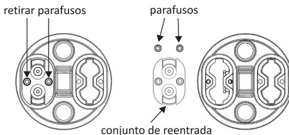
**9.3.2** Desmonte as travas plásticas da reentrada, conforme imagem ao lado e retire o grommet do alojamento interno oval. Retire os pinos de fechamento dos orifícios da borracha de vedação.
