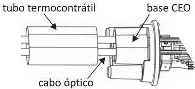
**Obs:** A borda sem adesivo do tubo termocontrátil deve ser orientada para o lado da base, enquanto que a borda que possui adesivo deve ficar orientada para o lado dos cabos.
