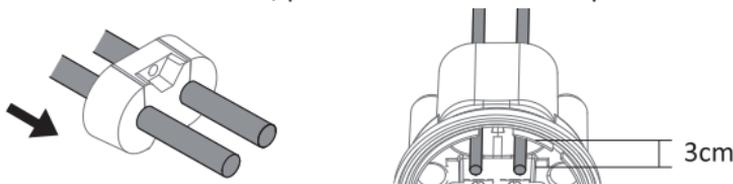
9.3.6 Fixe o elemento de tração na base da caixa utilizando a arruela de fixação e o anel de travamento com o auxílio de uma chave de fenda (não acompanha o produto), conforme imagens a seguir. Retire o excesso do elemento de tração.
