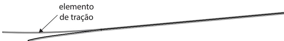
**8.4.5** Monte o conector de acordo com as especificações do fabricante e, em seguida, puxe o cabo para fora, verificando o comprimento ideal para acoplar o conector no adaptador.
