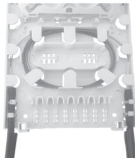
**8.2.3** Escolha uma das fibras do cabo de entrada para emendar no splitter e corte-a bem no meio (900mm). Execute a fusão com a fibra de entrada do splitter. Fixe o splitter óptico na região central, conforme a figura abaixo e faça a distribuição das fibras nas bandejas, lembrando que as fibras devem seguir os caminhos determinados na base da bandeja usando o caminho mais curto.
