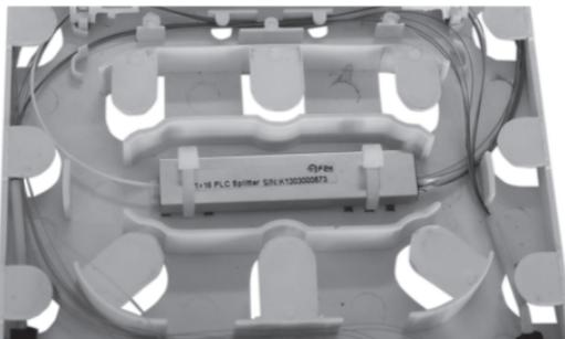
**8.1.4** Passagem das fibras na base das bandejas de fibra:
