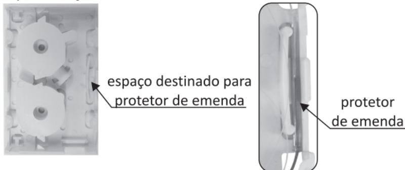
**8.1.4** Faça a acomodação das fibras conforme figura abaixo. Respeite os raios de curvaturas indicados para as fibras.
