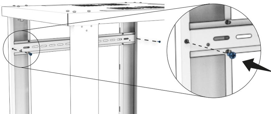
5.3.2 Fixe pelas abas da travessa nos cavaletes utilizando 2 parafusos cabeça panela M5 em cada lado.
