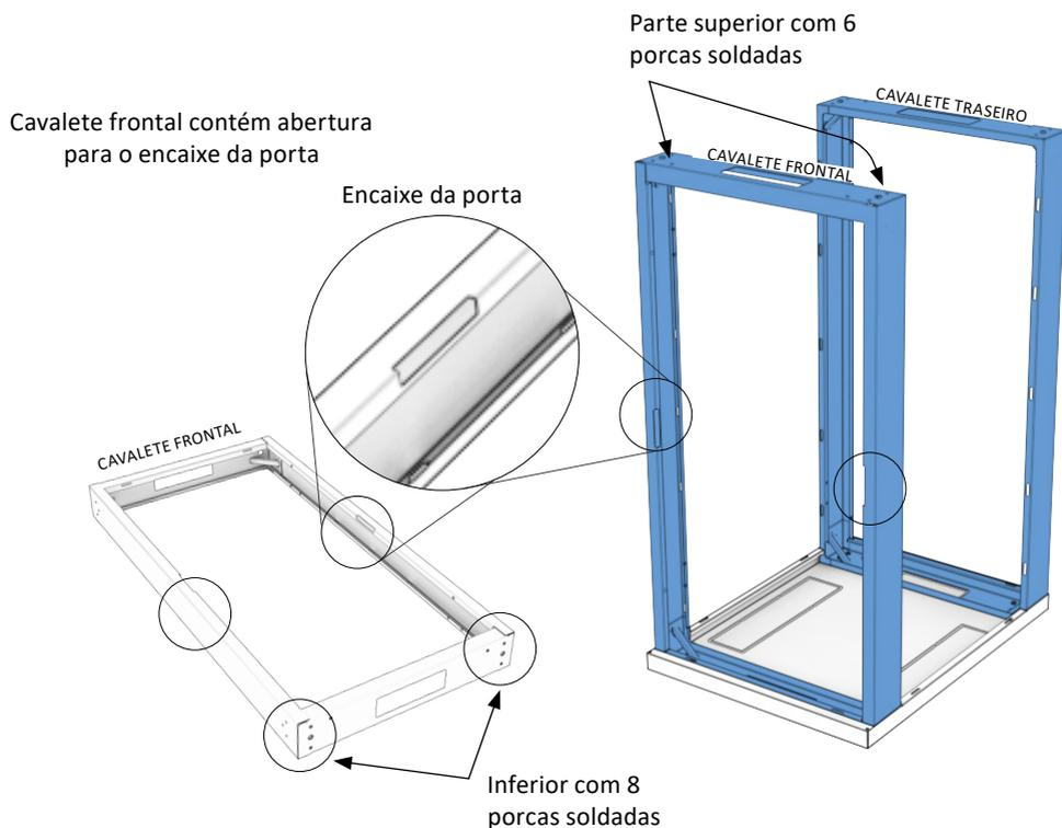
**5.1.2** Fixe os cavaletes na base inferior utilizando os parafusos cabeça panela M6 em cada lado:
