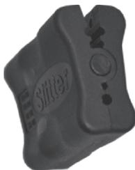
Cortador Longitudinal de Tubo Loose
