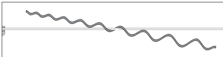
2. Inicie a aplicação do SVD em direção contrária ao acessório de fixação.
