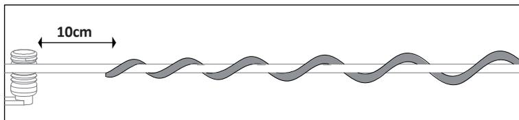
6. Amortecedor de vibração pré-formado totalmente aplicado.
