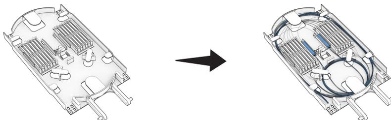
**9.3.3** Encaixe a tampa plástica. Acomode as sobras do tubo loose atrás das bandejas ou na bandeja de tubo loose (VENDIDO SEPARADAMENTE) e una com a fita velcro as bandejas com os tubos loose.
