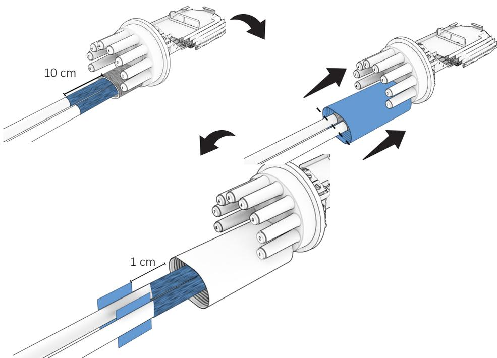
**9.2.5** Posicione o tubo termocontrátil sobre a entrada oval até encostar na base da caixa. Posicione o clipe metálico fazendo com que o tubo termocontrátil envolva os cabos ópticos e faça a união dos mesmos utilizando uma abraçadeira plástica à 5cm depois do alumínio.
