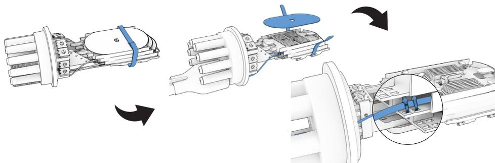
**9.3.2** As canaletas das bandejas podem alojar até duas emendas cada uma totalizando 24 fusões por bandeja. Realize as fusões das fibras e armazene-as nas canaletas das bandejas. Acomode as sobras das fibras nos arcos superior e inferior da bandeja.
