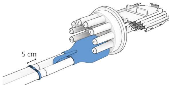
**9.2.6** Com a utilização de um soprador térmico realize a contração do tubo termocontrátil iniciando pela extremidade próxima à base da caixa, aquecendo toda a circunferência e direcionando no sentido dos cabos. Aqueça a extremidade do tubo até que todo o adesivo do clipe flua entre eles. De preferência mantenha o conjunto na posição horizontal durante este procedimento.
