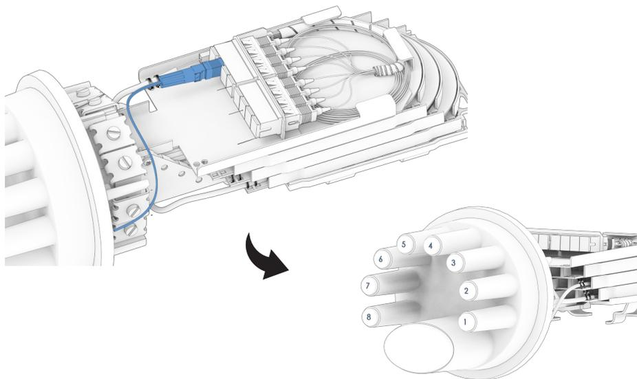
**9.7.4** Fixe o elemento de tração na base da CTO utilizando a arruela de fixação com auxílio de uma chave de fenda. Certifique-se que o elemento óptico contém uma folga para não exercer tração no conector de campo e evitar curvaturas acentuadas durante o manuseio da bandeja. Corte o excesso do elemento de tração.
