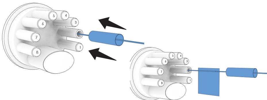
**9.9.3** Posicione o termocontrátil novamente sobre a entrada e com o soprador térmico, realize a contração aquecendo toda a circunferência, dando início pela extremidade próxima à base da caixa seguindo para os cabos, conforme imagem a seguir. Aqueça a extremidade do tubo até que o adesivo flua entre eles.
