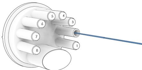
9.9.2 Posicione o tubo termocontrátil sobre a entrada até que sua extremidade encoste na base da CTO. Faça marcas nos cabos tomando como referência o final do tubo termocontrátil. Aplique uma tira de alumínio para cada cabo, avançando cerca de 1cm da marca no cabo, conforme imagem abaixo:
