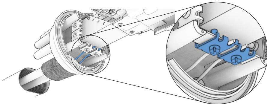
**9.2.4** Limpe e lixe os cabos até que fiquem totalmente ásperos. Os cabos devem ser lixados e limpos em uma área de aproximadamente 10 cm a partir da entrada oval. Posicione o tubo termocontrátil sobre a entrada oval até que sua extremidade encoste na base da caixa. Faça marcas nos cabos tomando como referência o final do tubo termocontrátil. Aplique uma tira de alumínio para cada cabo, avançando cerca de 1 cm da marca no cabo.
