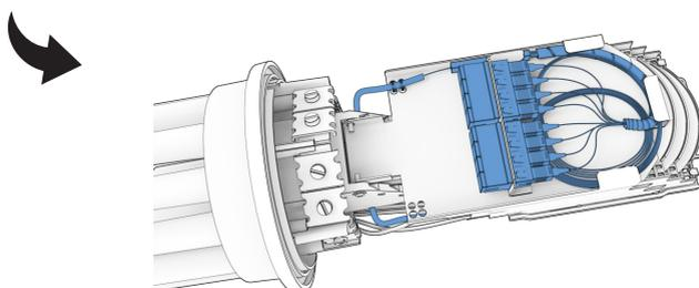
**9.4.1** Passe a entrada do splitter pelo tubo de passagem e fixe com duas abraçadeiras plásticas na bandeja metálica. Contorne o suporte de bandejas com o tubo de passagem e fixe-o com duas abraçadeiras plásticas na bandeja indicada.
