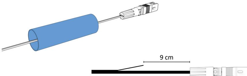
**9.7.3** Passe o cabo por dentro da derivação. Insira o conector de campo no adaptador óptico conforme a sequência numérica indicada.
