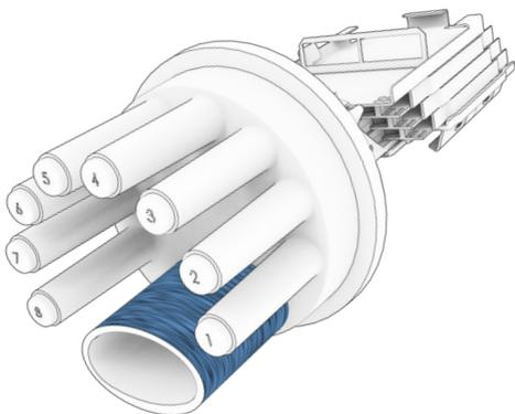
9.2.2 Posicione os cabos paralelamente um ao outro e passe o tubo termorretrátil sobre os mesmos. Passe os cabos pela entrada oval que foi aberta.
