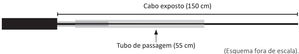
7.3 Efetue o acabamento entre a capa do cabo e as cânulas utilizando a fita de auto fusão, em sequência faça a identificação dos tubos *loose*.
