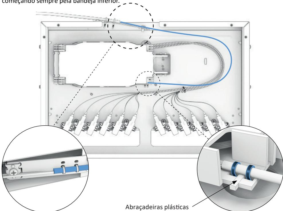
Fixação do cabo e do elemento de tração
