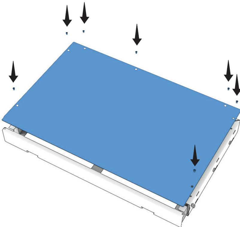
**8.7.2** Verifique o posicionamento que será colocado o DIO no rack e instale as porcas gaiolas no plano de fixação. Fixe o suporte nas laterais do DIO, conforme imagens abaixo e parafuse-o no plano de fixação do rack. Para fixação em racks padrão 19" posicione a parte **maior** do suporte no DIO. No entanto caso seu rack seja padrão 23" posicione a parte **menor** do suporte no DIO.
