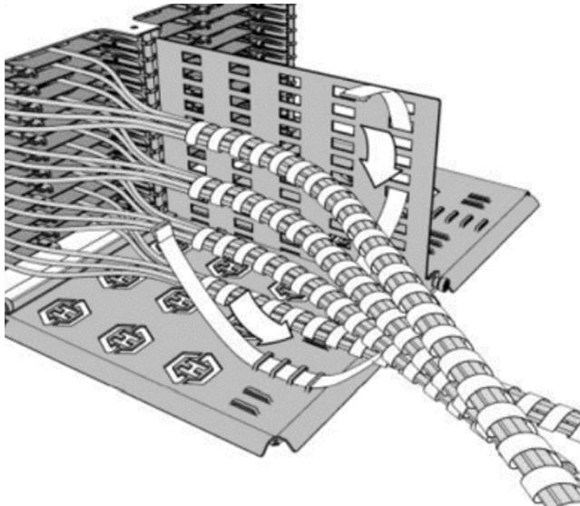
**Passo 7.** Cabeamento fixado no conjunto separador 4U e cabos direcionados pelas laterais.
