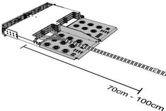
**Passo 2.** Organizar os cabos e passar fita velcro para direcionar o cabeamento.
