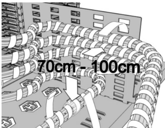
**Passo 8.** Fixação dos cabos e direcionamento pela lateral do gerenciador 4U.
