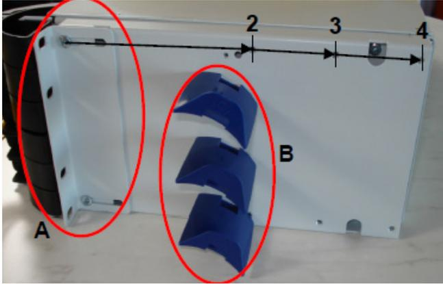
**Etapa 2.** Remova os mandris pretos na posição de fixação dos parafusos. Monte a ODU2 no rack, insira os parafusos e realize o encaixe dos mandris em sua posição de origem.
